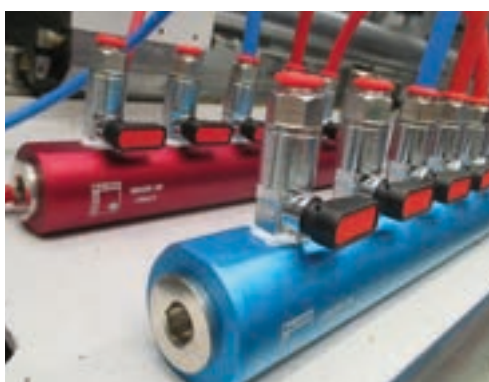
Esempio montaggio collettori a 6 uscite per gestione tubi raffreddamento stampo su presa.
